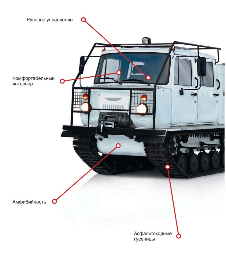
Отличительная особенность техники — улучшенная проходимость и возможность преодоления более сложных препятствий по сравнению с однозвенными снегоболотоходами, достигаемая за счет передачи крутящего момента двигателя на гусеницы обоих звеньев, низкого удельного давления на грунт, складывания звеньев без изменения тягового усилия и скорости, системы принудительного складывания звеньев в вертикальной плоскости.
