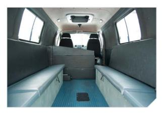
**Пассажирское отделение** имеет возможность трансформации в 4 спальных места и большие отделения для перевозки грузов.
