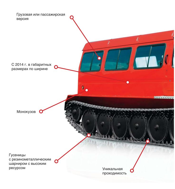
Отличительными особенностями снегоболотохода являются объемный монокузов, увеличенное количество посадочных мест и комфортабельный салон. Значительно усовершенствована эргономика рабочего места водителя, улучшена панель приборов, обзорность кабины и пассажирского салона. Измененная компоновка моторного отсека – двигатель перенесен в салон – облегчила обслуживание силового агрегата. Грузоподъемность машины увеличена до 2 тонн.
