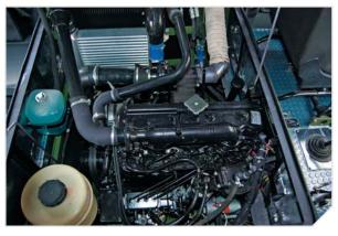
**Дизельный двигатель Д.245 7E2** зарекомендовал себя как надежный, неприхотливый и простой в обслуживании агрегат.
