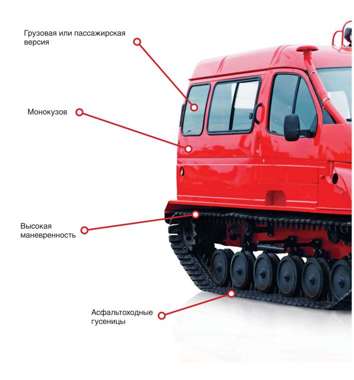
Отличительной особенностью снегоболотохода является высокая маневренность в ограниченном пространстве. На снегоболотоходе устанавливается асфальтоходный гусеничный движитель с резинометаллическим шарниром и со съемными резиновыми башмаками. Возможные варианты исполнения снегоболотохода:
