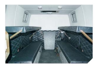
**Пассажирское отделение** имеет возможность трансформации в 4 спальных места и отделения для перевозки грузов.
