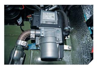
Предпусковой автономный подогреватель двигателя Webasto обеспечивает легкий запуск двигателя зимой и быстрый прогрев салона.
