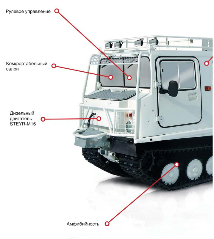
Отличительными особенностями двухзвенного гусеничного снегоболотохода ГАЗ-3351 является фибропластиковый водоизмещающий корпус переднего звена, армированный стекловолокном, с тепло- и шумоизоляцией из пенопласта (морозоустойчивый фиберглас), с независимым отопителем салона Webasto, рассчитанный на 5 человек. Модульная конструкция второго звена позволяет устанавливать любое технологическое оборудование в пределах грузоподъемности вездехода.
