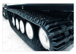
**Асфальтоходная цельнорезиновая гусеница** имеет высокий ресурс и обеспечивает рекордно низкое давление на грунт.
