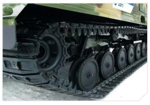
**Независимая торсионная подвеска ходовой части** обеспечивает уникальную плавность хода при движении по бездорожью.
