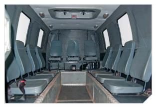
Пассажирское отделение второго звена имеет независимую систему обогрева отделения для перевозки грузов, комфртные сиденья.
