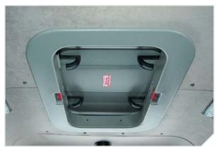
**Люк** обеспечивает дополнительную вентиляцию в летнее время.
