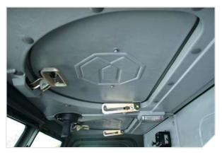
**2 люка** обеспечивают дополнительную вентиляцию в летнее время.
