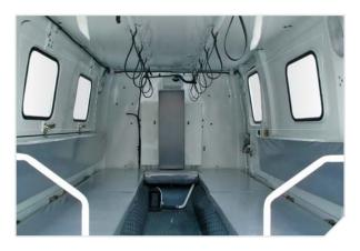
Пассажирское отделение второго звена имеет возможность трансформации в 4 спальных места и отделения для перевозки грузов.
