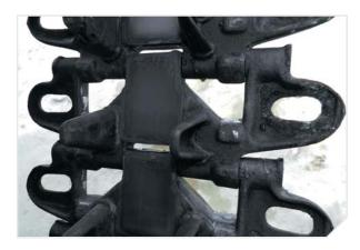
Гусеница с резинометаллическим шарниром (РМШ) обладает вдвое большим ресурсом относительно открытого шарнира (ОШ).
